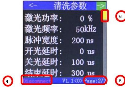
Figure 11 Cleaning parameter interface
